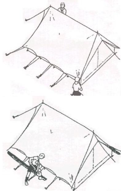
4.- Finalmente coloca los vientos de los parantes como se observa en la figura. Asegura bien estos vientos con estacas dobles y de buena calidad. (Coloca siempre alguna marca en los vientos para que no te tropieces con ellos). No olvides hacer canaletas para la lluvia
